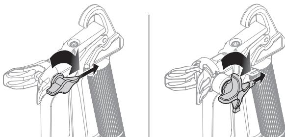
3. Desbloquee la pistola y apriete el gatillo mientras apunta la pistola hacia un retazo de madera o cartón. Esto permite que la presión de la manguera expela la obstrucción. Cuando la boquilla esté limpia, la pintura saldrá formando un chorro derecho a alta presión.
